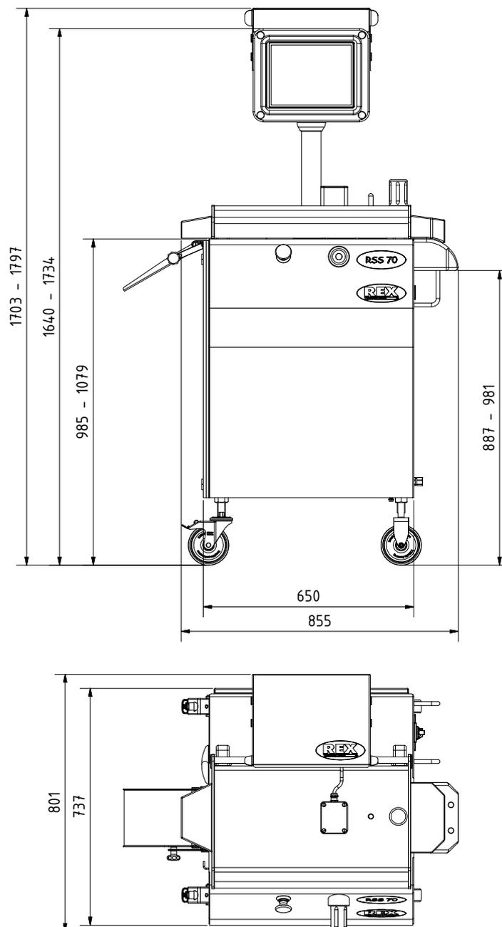
■ Габаритный чертеж линии в составе: шприц серии RVF 400 и RVF 700 с RKS 85 & RSS 70
